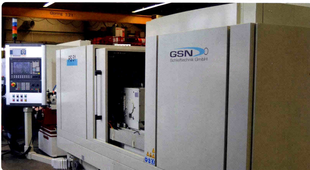
Bild 1: Praktisch wie neu: die überholte Schleifmaschine Schaudt PS 51
